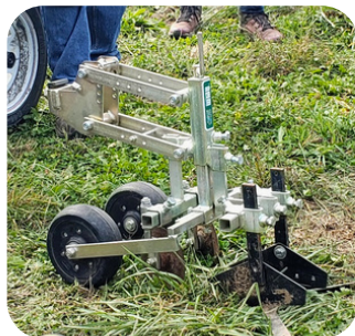
Roues de jauge (selon les modèles, elles peuvent être en caoutchouc ou en acier)
