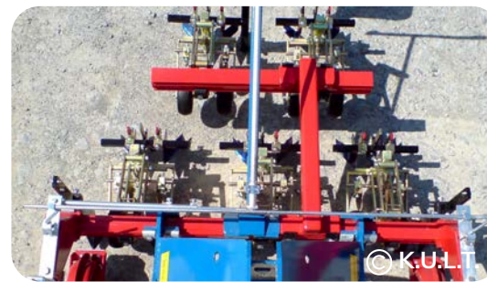
Parallélogramme-DUO + sarcleur ARGUS avec double barre porte-outils (K.U.L.T.)
