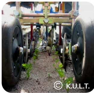
Montage standard + ajout de disques de 15 cm pour l'entre-rang
