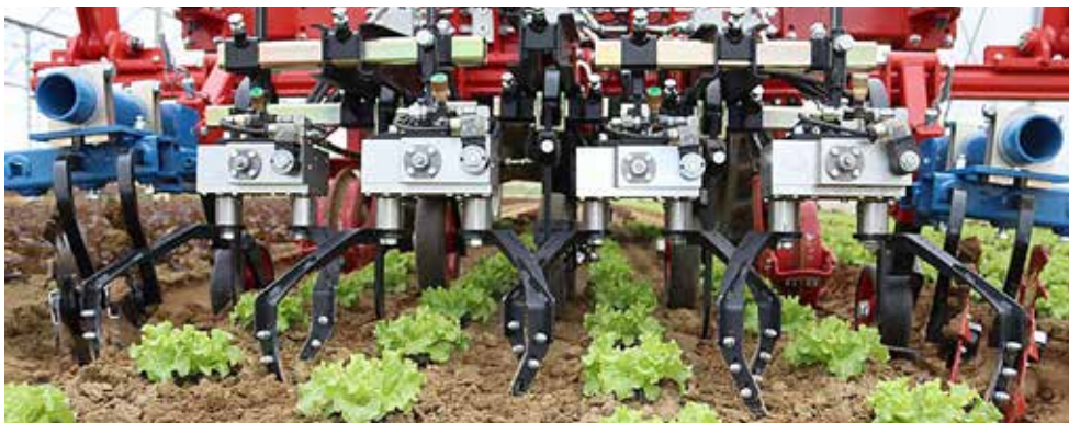
Robot désherbeur K.U.L.T. iSelect de la compagnie K.U.L.T. - Kress LLC
